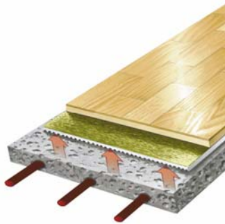
Bild: Aufbau einer Fußbodenheizung mit einem Holzbelag
